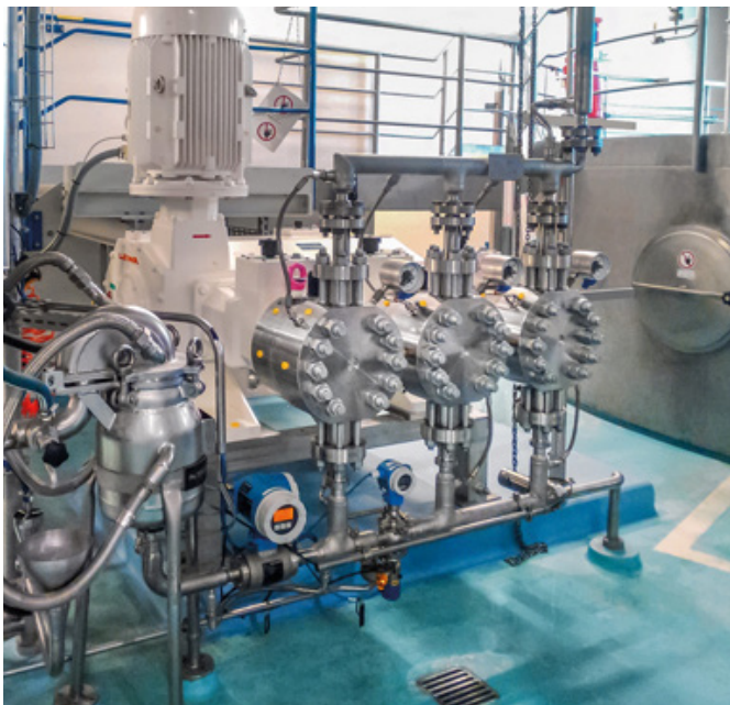
Die triplex Prozessmembranpumpe des Typs G3F zeichnet sich durch absolut sicheren Anfahren aus und erfüllt zudem die hohen Hygiene-Anforderungen der Lebensmittelbranche. (Quelle: DSM Nutritional Products GmbH)
