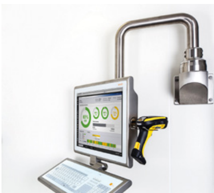
Abbildung 2: On-Wall Montage am U-Rohr-Tragarm. Mehrere drehbare Kupplungen erlauben die Rotation des HMI und des Tragarms um 350°. Die Kabelführung erfolgt reinraumkonform intern.
