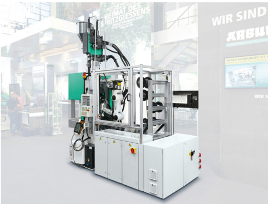
Flexible Serienfertigung „on demand“: Eine Turnkey-Anlage rund um einen vertikalen Allrounder 375 V und einen platzsparend angeordneten Sechs-Achs-Roboter produziert auf der Swiss Plastics Expo 2020 elastische Spannseile auf Kundenwunsch. (Foto: ARBURG)
