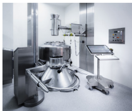
Abbildung 3: Mobiles HMI mit leistungsstarkem Akku im Fuß.
