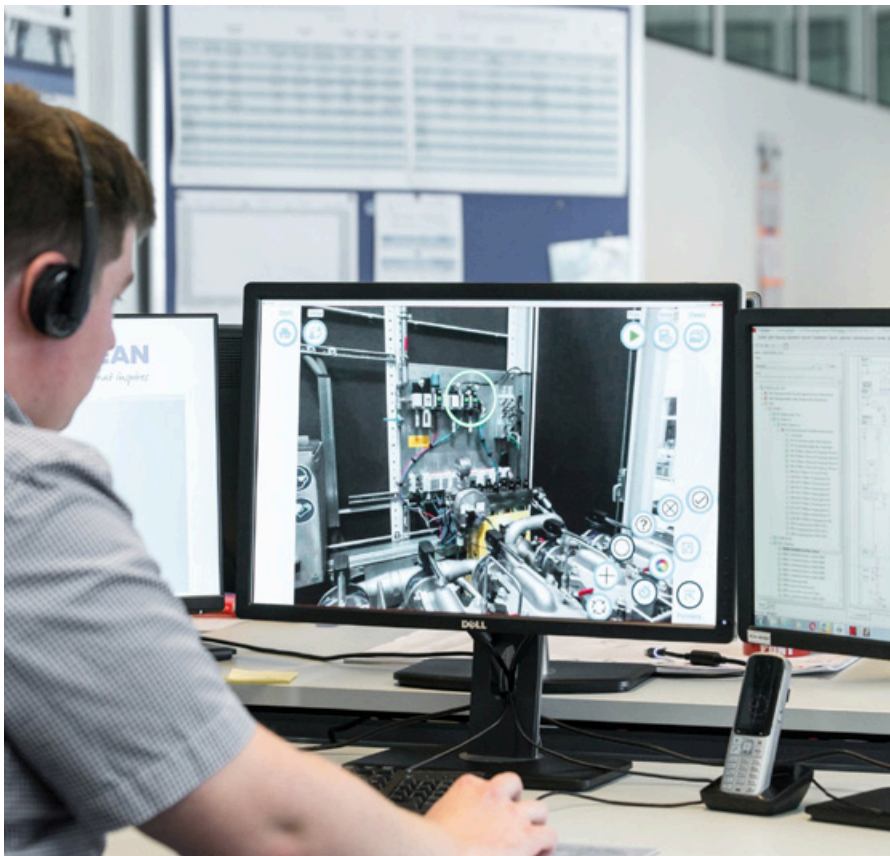
Der Remote-Service sorgt bei Störungen für eine schnelle und effiziente Hilfe aus der Ferne. Mit der neuen Service-App ist dabei der bidirektionale Austausch durch Video-Telefonie mit Livebild-Übertragung möglich. (Bildquelle: Ecoclean GmbH)
