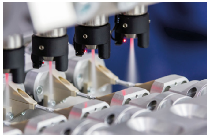
Das Industrie 4.0-kompatible Verfahren lässt sich in automatisierte Fertigungsumgebungen integrieren und die Qualität des Reinigungsstrahls kann mit Sensoren überwacht sowie in einen digitalen Wert übertragen werden. (Bildquelle: acp systems AG)
