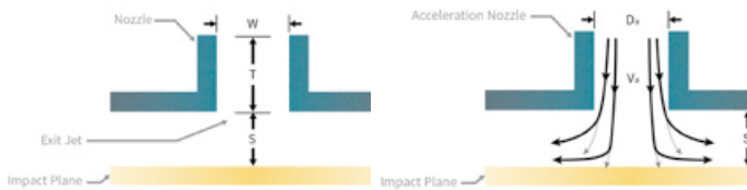
Abb. 2: Geometrie des aktiven Luftkeimsammlers
