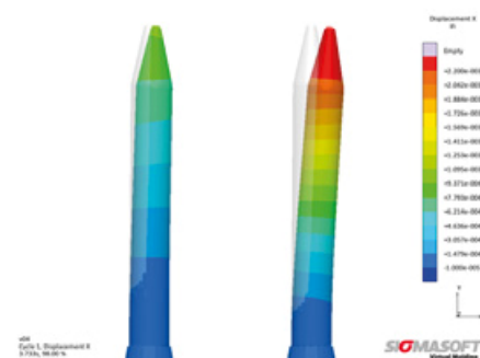
Bild 1 – Simulativer Vergleich der Deformation von Kernen aus Wolframcarbid (links) und aus 1.4034 (rechts) am Ende des Einspritzens – Unter konstanten Prozessbedingungen ist der Kern aus dem Material mit niedrigerem E-Modul am Ende des Füllens um das Dreifache verformt.
