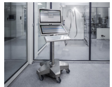
Abbildung 4: Mobiles HMI mit Doppel-Display zur zeitgleichen Darstellung mehrerer Applikationen.
