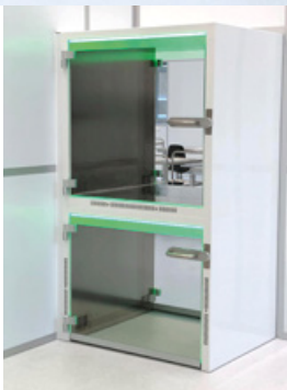
Materialschleusen und Türen beinhalten ein intelligentes Beleuchtungskonzept, das die Spülungszeiten berücksichtigt und anzeigt, wann eine Tür geöffnet werden darf.
