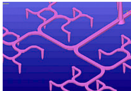
Bild 2: Unter Betrachtung der Scherung, des Druckbedarfs und des Anvernetzens, ermöglicht Sigmasoft® eine Optimierung des Angussvolumens in der Elastomerverarbeitung. Das Angussvolumen wurde um 47% reduziert. Links: ursprüngliches Konzept. Rechts: mit Sigmasoft® optimiertes Konzept.
