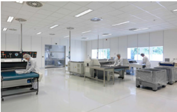
Reinraumproduktion ISO 7/8 zur Herstellung von Reinraumverpackungen bei der STRUBL KG.
