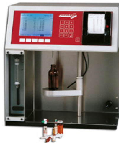
Das Partikelanalyseystem PAMAS SVSS misst Infusionen, Parenteralia, intravenöse oder ophthalmische Flüssigkeiten und andere pharmazeutische Suspensionen im Einklang mit der Pharmakopöe USP. Die Auswertung der Messdaten erfolgt mit Hilfe des Softwareprogramms PAMAS USP. Dank eines speziellen Zubehörs für geringe Probenmengen kann ab sofort auch die Norm USP 787 für therapeutische Proteinlösungen erfüllt werden. (Foto: PAMAS)
