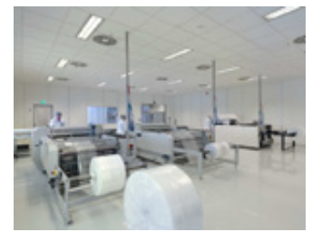
Reinraumproduktion zur Herstellung von Reinraumverpackungen.
