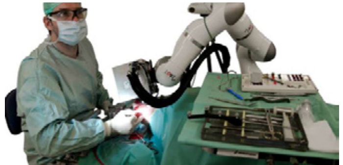
Roboter CARLO (Computer Assisted Robot-guided Laser Osteotome) schneidet Knochen kontaktfrei und höchst präzise. (Foto: AOT AG Basel)
