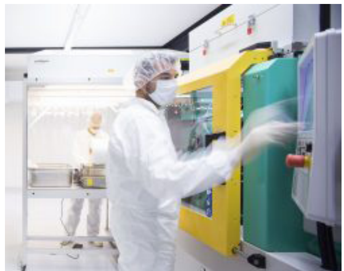
Für die medizinischen Tests produzierte 1zu1 Prototypen die Spritzgussteile im neu eröffneten Reinraum.
