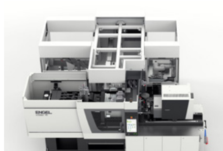
Auf einer vollelektrischen e-motion 170/110 T Spritzgießmaschine fertigt ENGEL an seinem Messestand vollautomatisiert Interdentalbürsten. (Bild: ENGEL)
