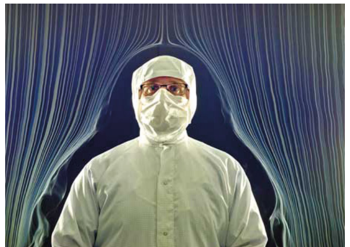
Bild 5: Visualisierung der Umströmung einer Person in einer turbulenzarmen Verdrängungsströmung
