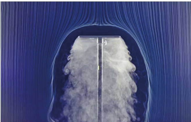
Bild 3: Visualisierung der Umströmung eines Hindernisses in einer turbulenzarmen Verdrängungsströmung
