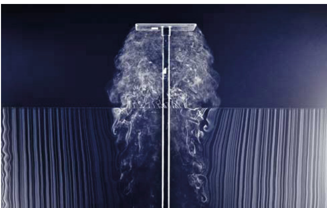
Bild 4: Visualisierung des Rückströmgebiets unterhalb eines Hindernisses in einer turbulenzarmen Verdrängungsströmung
