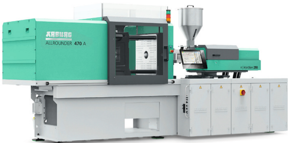
Auf der Plastec West fertigt ein elektrischer Allrounder 470 A vollautomatisch Pumpenköpfe für die Medizintechnik. (Foto: ARBURG)
