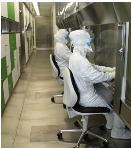
Abb. 2: Rechter Herstellungsraum, Team an 2 Bänken, Laminarflow von der Decke, Doppelboden V4A
