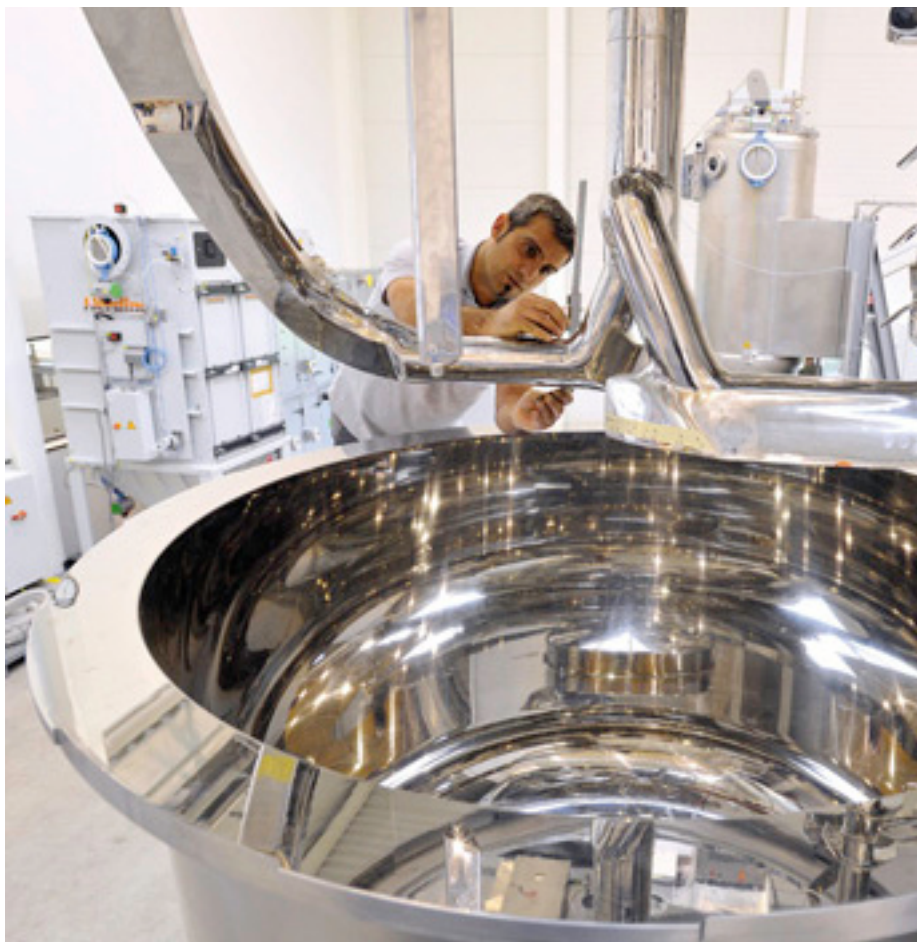
Hüttlin Gentlewing: Durch die spezielle Geometrie erzielt das Mischwerkzeug Hüttlin Gentlewing von Bosch Packaging Technology höchste Mischgüte bei geringer mechanischer Beanspruchung des Produkts.
