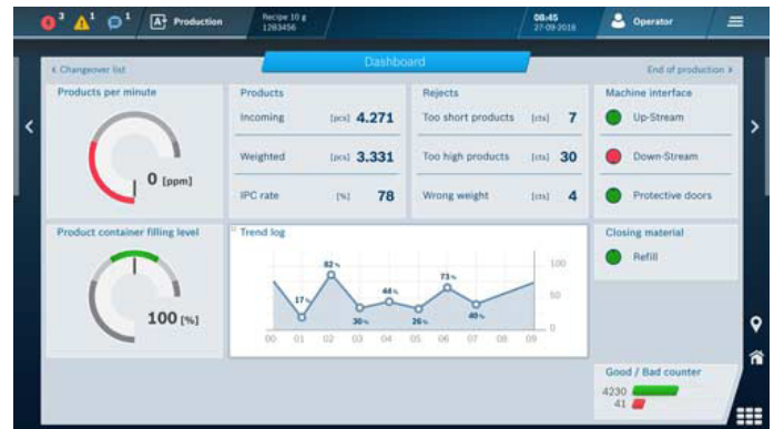
Condition Monitoring liefert Informationen zu einzelnen Maschinen oder Gesamtlinien in Echtzeit. Anhand vordefinierter Warn- und Fehlergrenzen kann man Abweichungen frühzeitig erkennen und beheben. (Foto: Bosch Packaging Technology)
