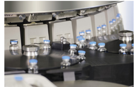
Inspektion von bis zu 600 Glasbehältnissen pro Minute basierend auf Gruppenprüfung: Die KLV 1360 erzielt ihre Höchstleistung dank spezieller Prüfkammern, in denen die Behältnisse wahlweise einzeln oder gruppenweise geprüft werden. (Bild: Bosch)
