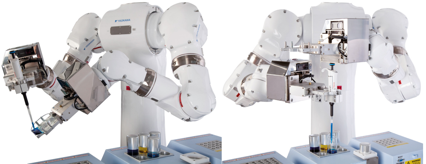
Ein speziell für die Laborautomatisierung entwickelter Roboter ist der Dual-Arm-Roboter Motoman CSDA10F von Yaskawa. (Quelle: Yaskawa)
