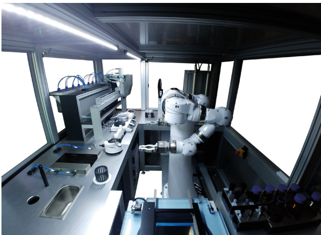
In einem aktuellen Entwicklungsprojekt werden mit dem CSDA10F etwa ein Dutzend Prozesse für die vollautomatische Produktion von Nanopartikeln verkettet ausgeführt. (Quelle Anlage: Goldfuß engineering GmbH)
