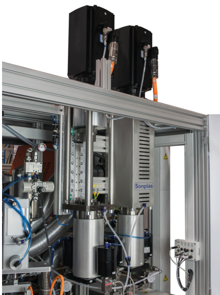
Plungerpumpen eignen sich für kleine oder große Fördermengen, erzielen verschiedene Druckstufen und sind in der Lage, alle flüssigen Medien zu fördern. (Bild: Sonplas GmbH)
