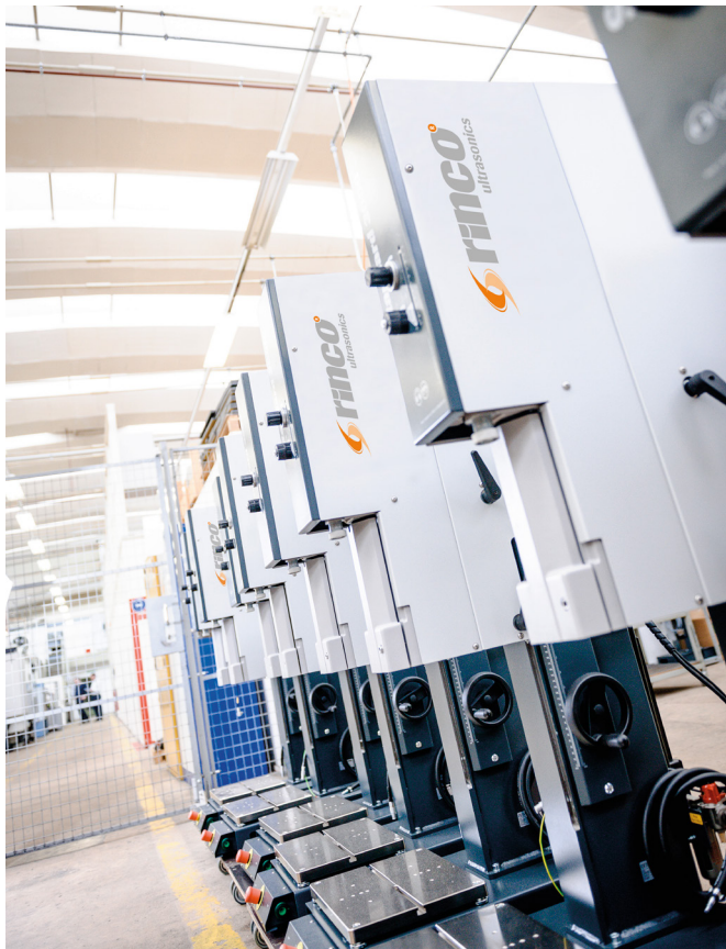
Mit Ultraschall-Schweissmaschinen lassen sich medizinische Geräte sehr schnell und zuverlässig schweißen. (Bild: Rinco Ultrasonics AG)
