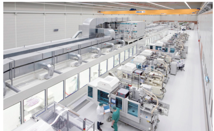
Bei Pöppelmann FAMAC produzieren die Spritzgussmaschinen von außen in den Reinraum hinein, sie können bei Bedarf abgekoppelt und in anderen Bereichen eingesetzt werden.
