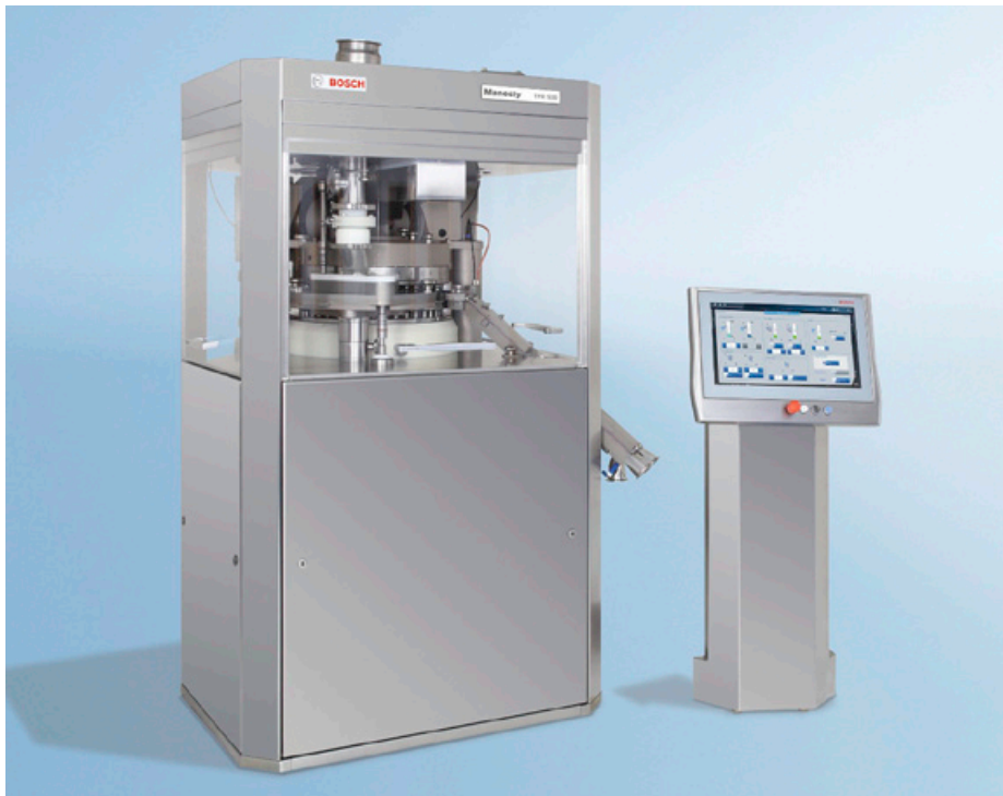
Neue Manesty TPR Tablettenpressenserie von Bosch: Alle drei Maschinen der Manesty TPR Tablettenpressenserie wurden mit dem Ziel entwickelt, die Gesamtanlageneffektivität hinsichtlich Verfügbarkeit, Qualität und Ausbringung beträchtlich zu steigern.
