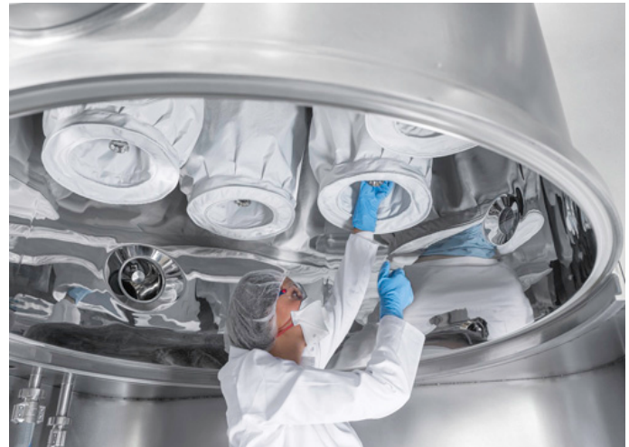
Entscheidend für hohe Ausbeute: die Prozessfilter Für eine hohe Ausbeute im Wirbelschichtmodul der neuen GranuLean hat Bosch einen neuen Prozessfilter entwickelt.
