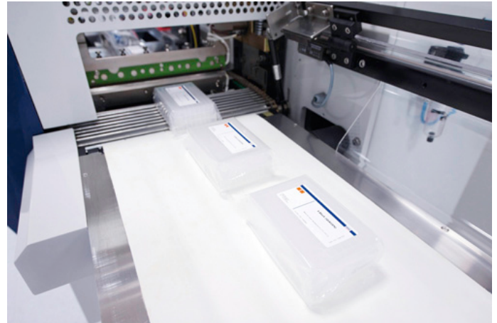
Auch die Konfektionierung findet bei Pöppelmann FAMAC im Reinraum statt, dort ist gewährleistet, dass sich weniger als 350.000 Partikel / ccm (< 0,6 µm) in der Luft befinden.
