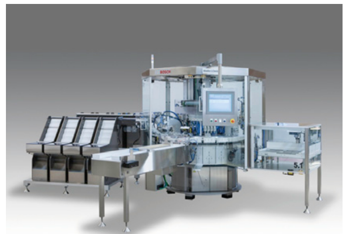
Pen-Montageplattform MRA: Die MRA von Bosch eignet sich für die Montage medizinischer Produkte wie Pens, die beispielsweise in der Diabetestherapie zum Einsatz kommen.
