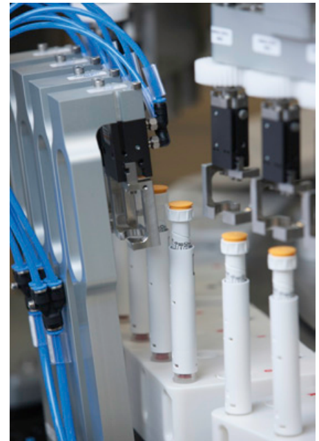
Vier Pens gleichzeitig: Die Montageplattform MRA von Bosch montiert zuverlässig die vier Bestandteile von Standard-Einweg-Pens: Pen-Kappen, Karpulenhalterungen, Karpulen und Dosiermechanismen.
