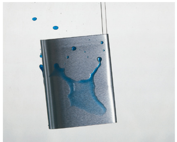
Zu den filmischen Verunreinigungen gehören Öle und Fette, aber auch Rückstände von Korrosionsschutzmitteln, Beschichtungen, Kühlschmierstoffen und weiteren Fertigungshilfsmitteln. (Bild: SurTec)
