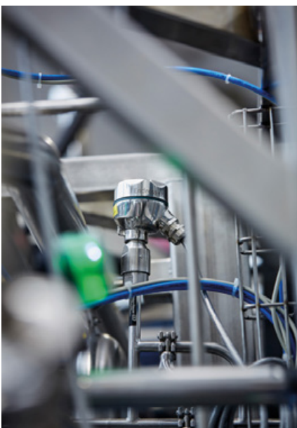
Abb. 1: Die Sterilisation mit Reinstampf (SIP) wird an vielen Punkten in den Anlagen mit Temperaturfühler überwacht – hier ein Modell mit Quick-Neck-Schnellverschluss für einfacheres Kalibrieren. (Bild: Endress+Hauser)
