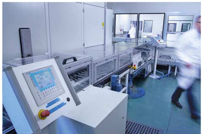
In der EJOCLEAN® Reinigungsanlage wird die Ware auf das erforderliche Sauberkeitsniveau feinstgereinigt.
