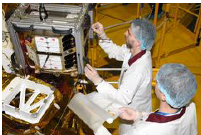
Wissenschaftler der TU Berlin bauen „TechnoSat“ in Baikonur an die Oberstufe der dreistufigen Sojus-Rakete an. (© TU Berlin/ILR)
