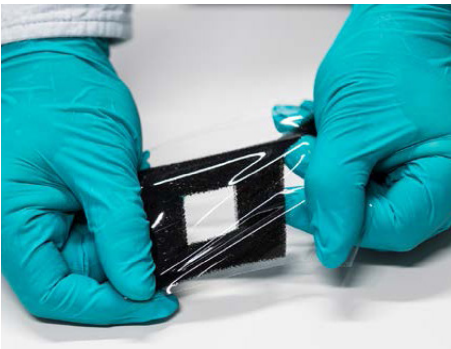
Mit seiner elastischen Form lässt sich der Näherungssensor flexibel auf großen Oberflächen anbringen. (Quelle: Fraunhofer IPA, Foto: Rainer Bez)
