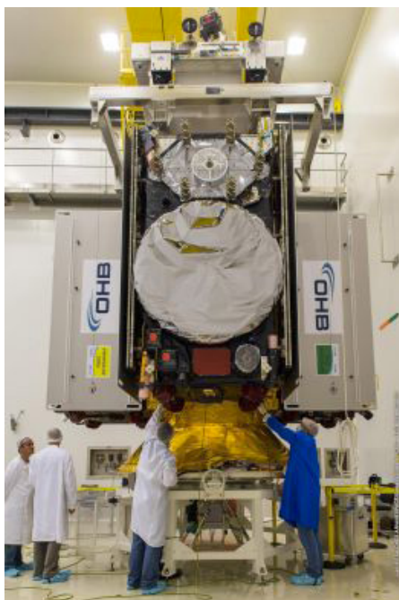
Galileo FOC Satelliten von OHB beim so genannten „Fit-Check“ in einem Reinraum am Weltraumbahnhof in Kourou, Französisch-Guayana. (© ESA/CNES/ARIANESPACE)
