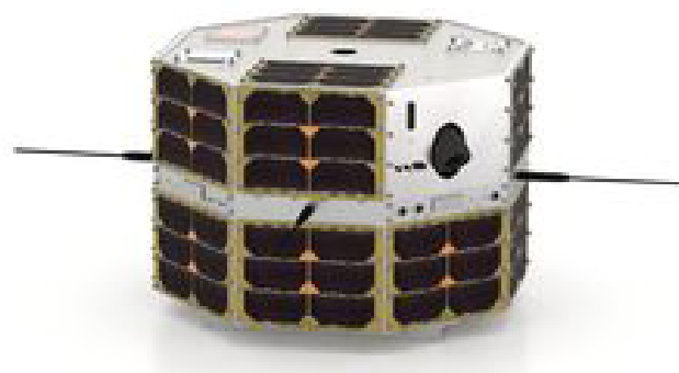
Der Kleinsatellit „TechnoSat“ hat ein Maß von 305 x 465 x 465 Millimeter. (© TU Berlin/ILR)
