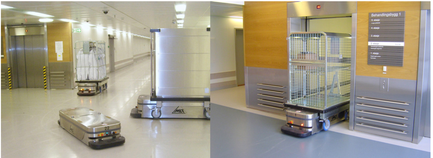
Fahrerloser Unterfahrschlepper Caesar für den automatisierten Transport in Kliniken und Krankenhäusern (Quelle: MLR Gruppe)
