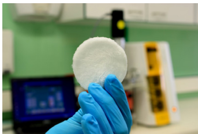
Abb. 2: Wundauflage (Nonwoven/Vlies) aus Alginatefasern bakterieller Quelle. Bakterielle Alginate-Vliese nehmen bis zu 70% mehr Flüssigkeit auf als marine Alginate-Vliese. © Hohenstein Institute
