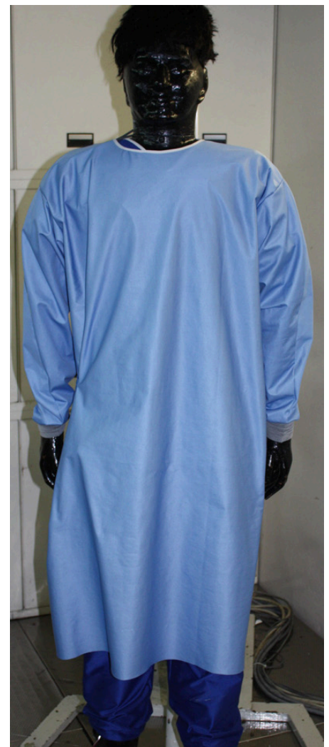
Mit Hilfe der thermischen Gliederpuppe „Charlie“ lassen sich Kennzahlen zum Wärme- und Feuchtmanagement (Wärmeisolation und Atmungsaktivität) sowie der Feuchttransport von Kleidung aller Art ermitteln. © Hohenstein Institute
