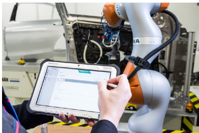
Mit »dragBot« können Roboterprogramme auf einfache und intuitive Art erstellt werden. (Quelle: ARENA2036, Foto: Rainer Bez)
