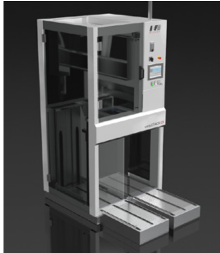
Mit dem varioSTACK CF hat IEF-Werner ein ganzheitliches Palettierer-Konzept für Reinraumanwendungen entwickelt. (Bild: IEF-Werner GmbH)
