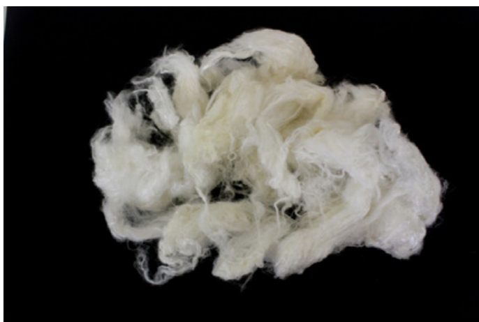
Abb. 1: Alginate-Viskose-Fasern, hergestellt mit bakteriellem Alginate. © Hohenstein Institute
