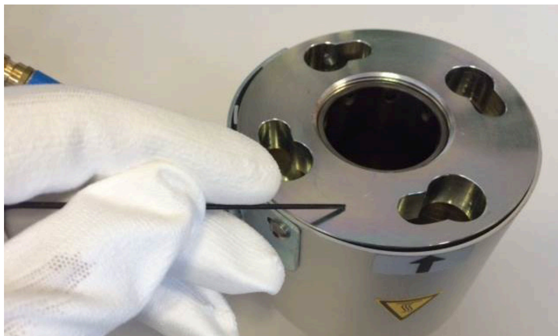
Gezielte Kontamination von Bauteilen mit Normpartikeln
