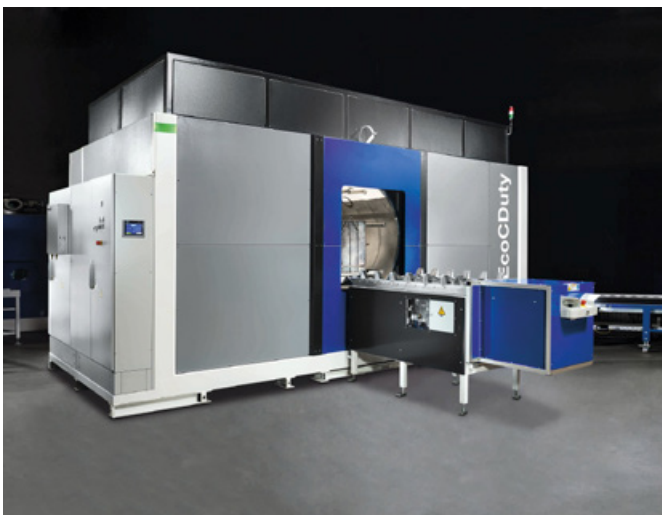
Die modular aufgebaute, unter Vollvakuum arbeitende Großkammer-Lösemittelreinigungsanlage EcoDuty kann mit Kohlenwasserstoffen oder modifizierten Alkoholen betrieben werden. Die Arbeitskammer ist für Chargen mit Abmessungen bis 1.250 x 840 x 970 mm und einem Gewicht bis zu einer Tonne ausgelegt. (Foto: Ecoclean GmbH)
