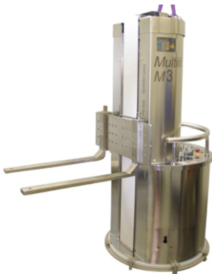
Spurenlos unterwegs: Der Multilift von EAP Lachnit fährt mit SEMI-Zertifizierung auf Luftkissen durch Reinräume oder Ex-Bereiche.
