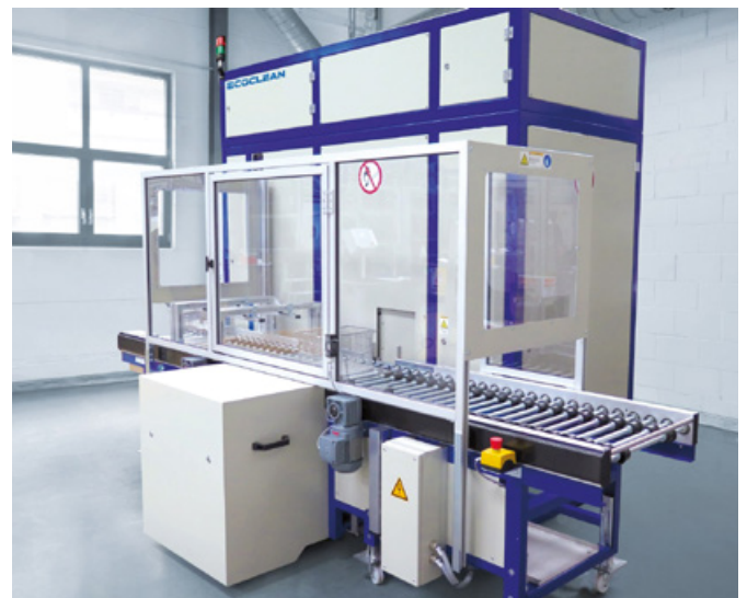
Die kompakte Minio 85C ermöglicht die zuverlässige und wirtschaftliche Entfettung und Reinigung mit nicht-halogeniertem Kohlenwasserstoff zwischen oder nach Fertigungsprozessen. (Foto: Ecoclean GmbH)
