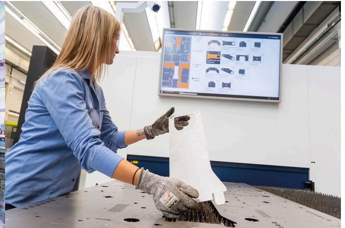
Sorting Guide: Ein Ergebnis der Kooperation ist der Sorting Guide von TRUMPF, der mittels KI Mitarbeiter bei der Entnahme lasergeschnittener Blechbauteile unterstützt. (© TRUMPF)
