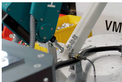
An der CNC-Fräsmaschine arbeitet HORST, wie es ein menschlicher Maschinenbediener täte. Er nimmt das Endstück einer Rotationsdüse auf ...
