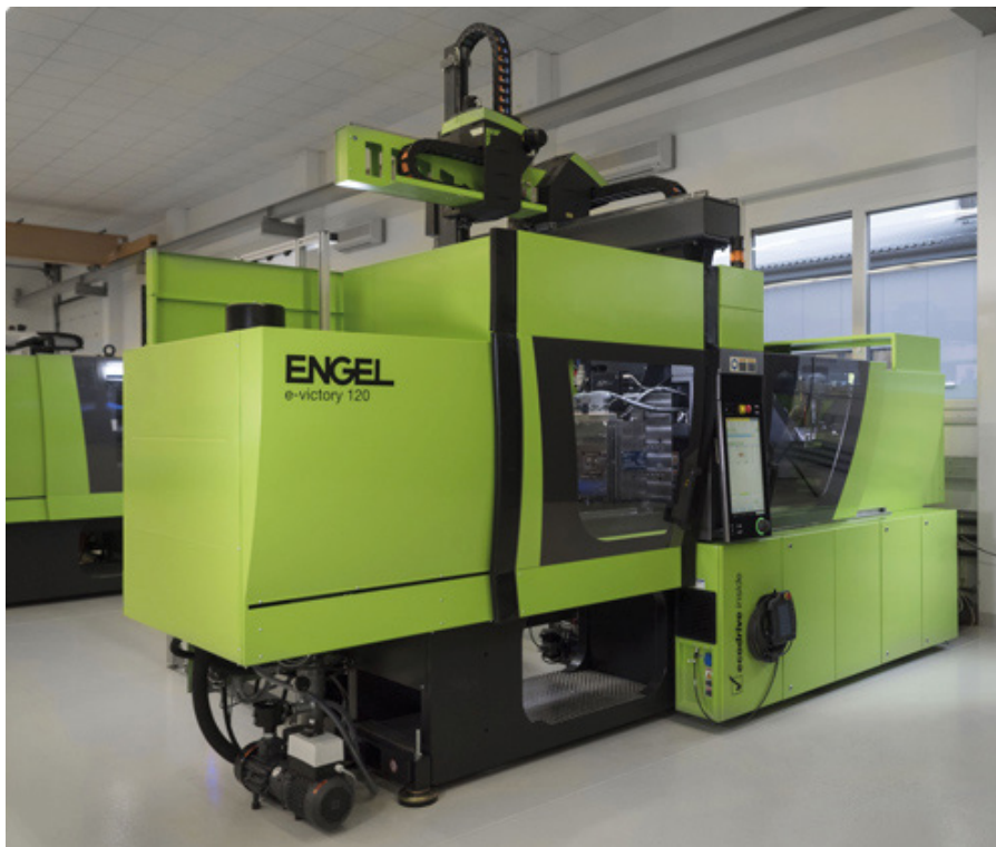
Dank ihrer barrierefreien Schließeinheit eröffnet die holmlose e-victory Spritzgießmaschine in der Verarbeitung von Flüssigsilikon ein großes Effizienzpotenzial. (Bild: ENGEL)
