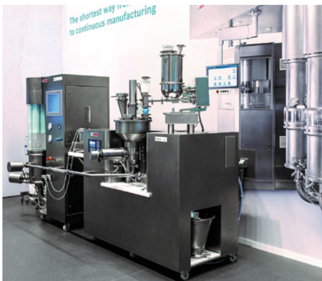
Xelum R&D von Bosch: Das R&D Gerät zur Herstellung oraler fester Darreichungsformen (OSD) ermöglicht eine kurze Markteinführungszeit und eine optimale Dosierung kleinster Wirkstoffmengen. (Foto: Bosch)
