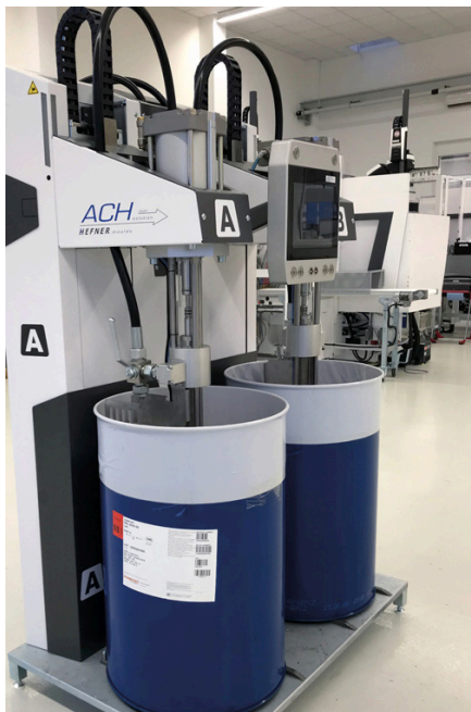
Für die Dosierung des Flüssigsilikons kommt eine Maxi-Mix G2 von ACH-Solution zum Einsatz. Der Gesamtprozess lässt sich bequem über das CC300 Bedienpanel der ENGEL Spritzgießmaschine steuern. (Bild: ACH-Solution)
