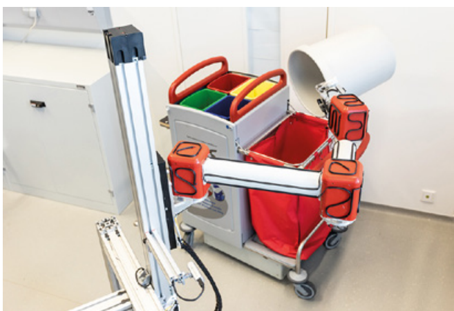
Der Roboterarm kann Papierkörbe selbstständig erkennen, greifen und den Inhalt in einen Sammelbehälter entleeren. (Quelle: Fraunhofer IPA /Foto: Rainer Bez)
