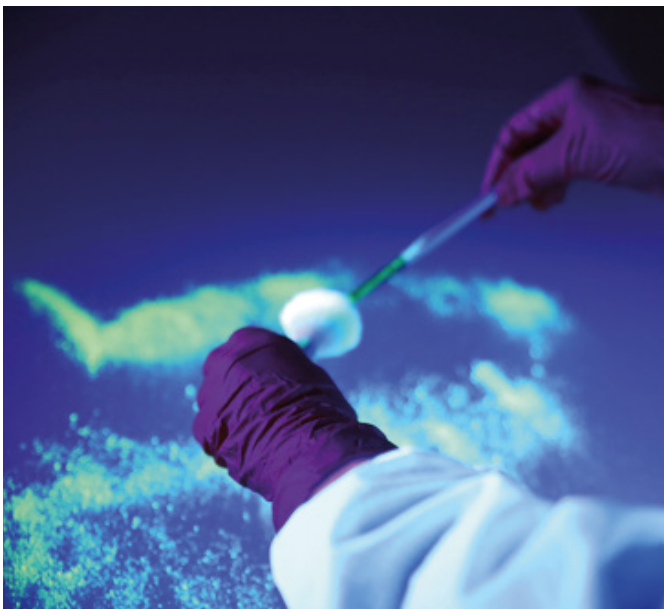
Unter Schwarzlicht werden Verunreinigungen sichtbar, die mit bloßem Auge nicht zu erkennen sind. (Piepenbrock Unternehmensgruppe GmbH + Co. KG)
