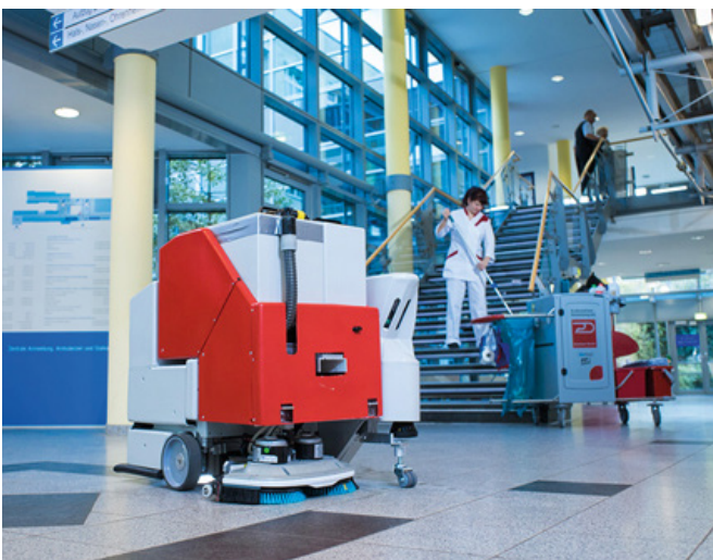
Der Reinigungsroboter mit Nassreinigungsmodul beim Praxistest in einem Krankenhaus. (Quelle: Dussmann Group/Fotograf: Kay Herschelmann)
