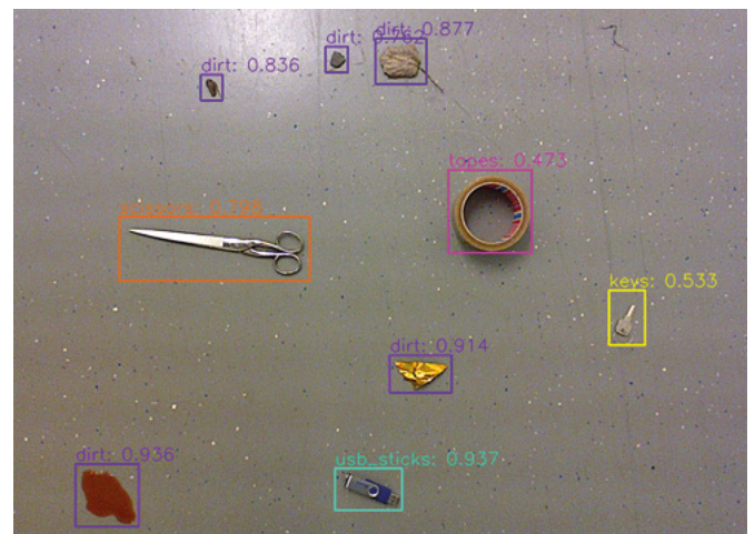
Die am Fraunhofer IPA entwickelte Software erkennt automatisch Schmutzpartikel und unterscheidet diese von Bürogegenständen, die ebenfalls auf dem Boden liegen könnten. (Quelle: Fraunhofer IPA)
