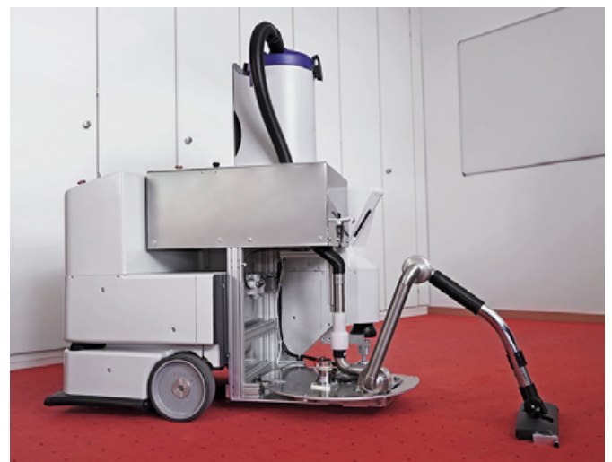
Der Reinigungsroboter mit dem Modul zum Staubsaugen bei der Erprobung in den Büroräumen der Dussmann-Hauptverwaltung in Berlin. (Quelle: Fraunhofer IPA)
