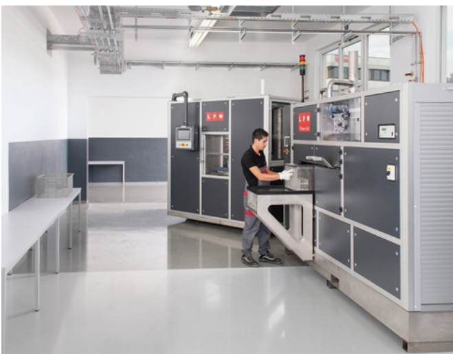
Die Eingangsqualität muss gewährleistet werden. Eine Vorreinigung als Quality-Gate ist zur Aufrechterhaltung der Prozess-Sicherheit obligatorisch. (Foto: LPW)
