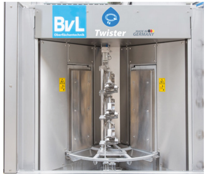
Jeweils drei zu reinigende Drosselklappen werden vom Roboter auf die speziell gefertigten Werkstückträger aufgesetzt und rotieren im automatischen Taktverfahren durch die Behandlungskammern.
