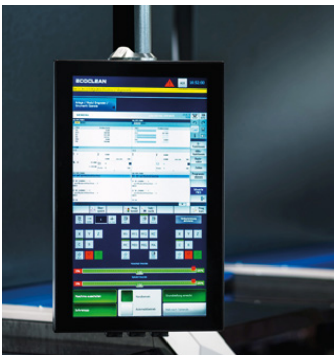
Auf dem 19 Zoll großen Flatscreen-Bildschirm (HMI) des neuen, intuitiven Bedienpanels wird jedes Modul der Anlage in einer Komplettübersicht, ähnlich wie auf einem Smartphone, separat und übersichtlich dargestellt. (Bildquelle: Ecoclean GmbH)
