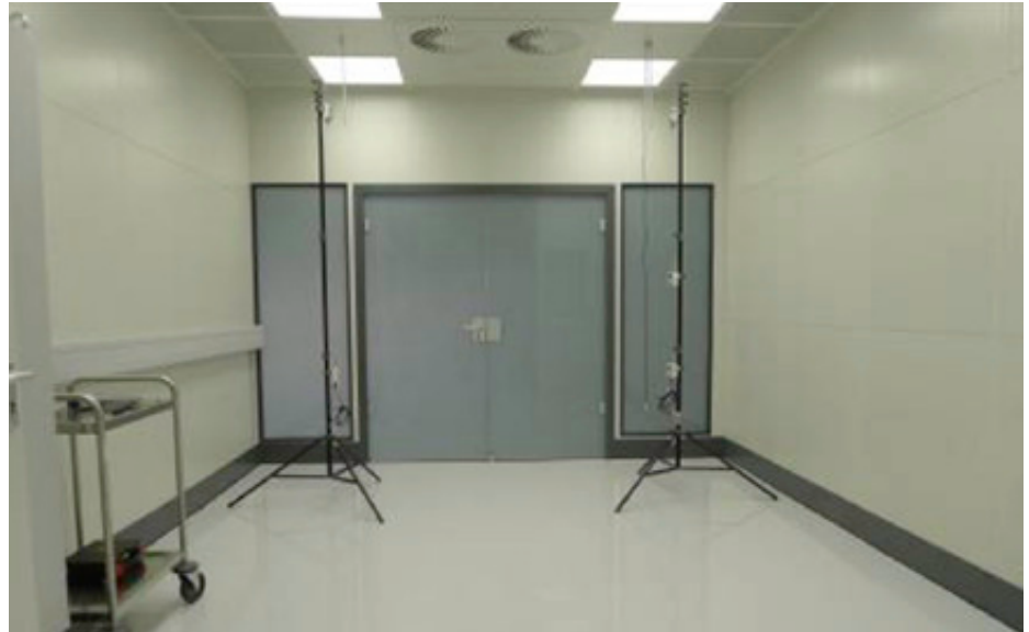
Im neuen Forschungslabor von Nerling sollen zukünftig die Auswirkungen von Störquellen in hochgenauen Räumen näher untersucht werden. Dazu wurden im Messraum der Güteklasse I erstmals die neuen, energiesparenden LED-Lampen eingebaut.
