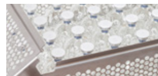
Werkstückträger von Hubl: In einem stapelbaren Blechkorb werden Glas-Ampullen mit hochwertigen Flüssigkeiten automatisch befüllt, transportiert, gereinigt und sterilisiert.
