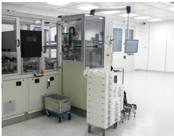
Herzstück der Anlage ist ein flexibles Palettiersystem von IEF-Werner. (Bild: IEF-Werner GmbH)
