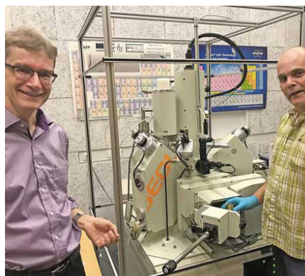
ZELMI-Leiter Dr.-Ing. Dirk Berger (l.) und Dipl.-Ing. Jörg Nissen bereiten an der Feldemissions-Elektronenstrahlmikroskope eine Messung vor. Der umgebende Magnetfeldrahmen verhindert Störungen, die den Elektronenstrahl ablenken und das Ergebnis verfälschen könnten. (© TU Berlin/PR/Patricia Pätzold)
