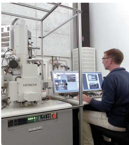
Hochauflösendes Rasterelektronen-Mikroskop (© TU Berlin/ZELMI)
