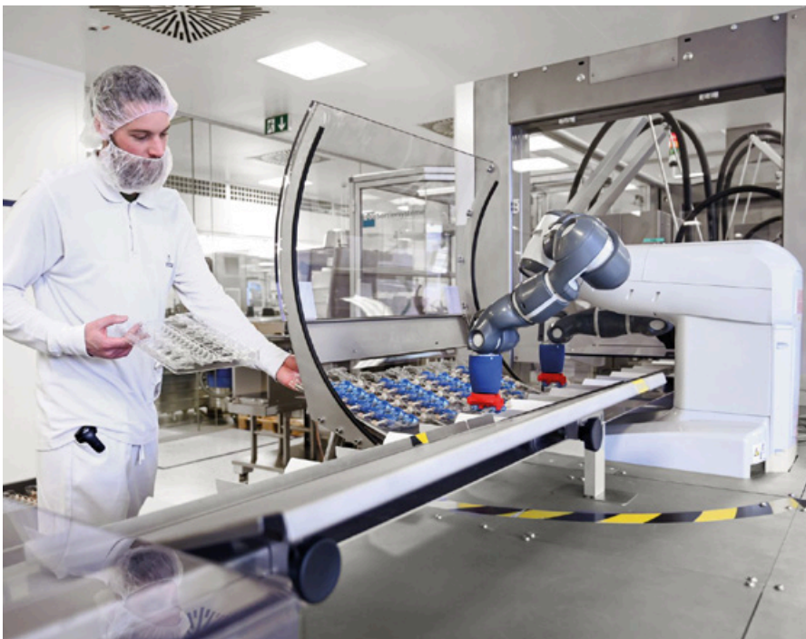
Zusammenarbeit von Mensch und Maschine in der Endverpackung. (Bildquelle: Vetter Pharma International GmbH)
