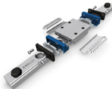
Zu den konstruktiven Vorzügen der neuen LLS-Miniatur-Profileschienenführung gehören unter anderem der optimierte Kugellauf sowie das den Wartungsaufwand minimierende Schmierstoffreservoir samt verbesserter Dichtung. (Bild: Ewellix-Gruppe)
