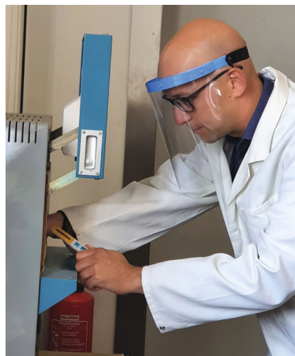
Großflächiger Spritzschutz: Der Kager Face Protector (KFP) ist zertifiziert nach DIN EN 166 (Persönlicher Augenschutz) und DIN EU 2016/425 (Persönliche Schutzausrüstung/PSA). (Bild: Kager)
