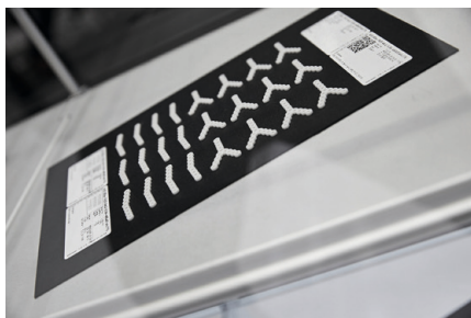
Die Firma Samplast verarbeitet mit dem Freeformer 200-3X im AKF-Verfahren resorbierbare Originalmaterialien zu knochenähnlichen Implantaten. (Foto: Arburg)
