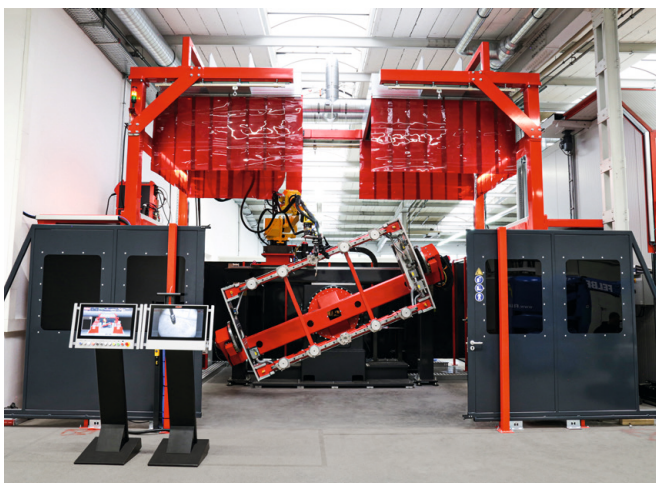
Die Roboterschweißzellen im Fronius Prototypen-Zentrum sind mit modernster Spann-, Sensor- und Schweißtechnik – etwa dem CMT-Prozess – ausgestattet. (Foto: Fronius International GmbH)
