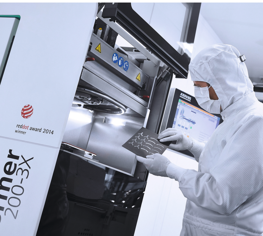
Die Firma Samplast verarbeitet mit dem Freeformer 200-3X im AKF-Verfahren resorbierbare Originalmaterialien zu knochenähnlichen Implantaten. (Foto: Arburg)
