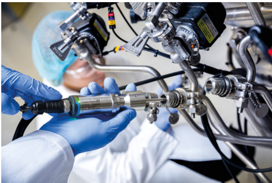
Fig. 1: Ce nouveau capteur de température à calibration automatique permet d'éviter 3000 interruptions de processus par an dans la production d'huiles et de matières grasses. (Photo: Endress + Hauser)
